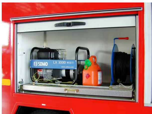
Un groupe électrogène fournit l'énergie nécessaire à l'autonomie de l'engin, en particulier pour l'éclairage.
