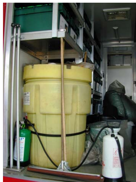
Parmi les nombreux équipements transportés, signalons des bacs de récupération, le matériel pour obturer des bouches d'égout, des appareils respiratoires isolants, des tenues de protection étanches...
